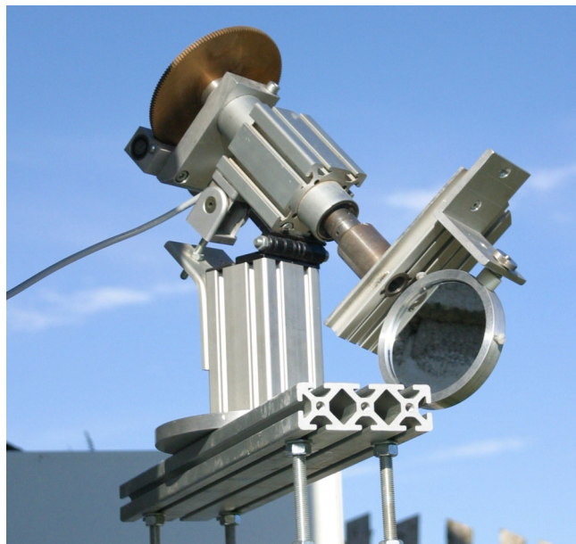
Abb. 1.2: Der „ein-Spiegel Heliostat“, damit wird das Licht in den SHC geleitet.
