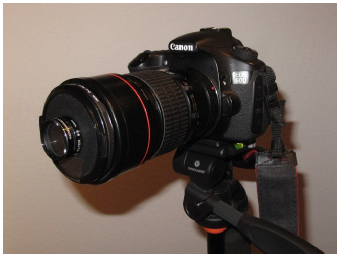
Abb. 1.11: Der SA 100 am 200er Tele, eingepasst in einen Objektivdeckel. Für helle Sterne braucht es keine Nachführung, was den Einsatz erheblich erleichtert
